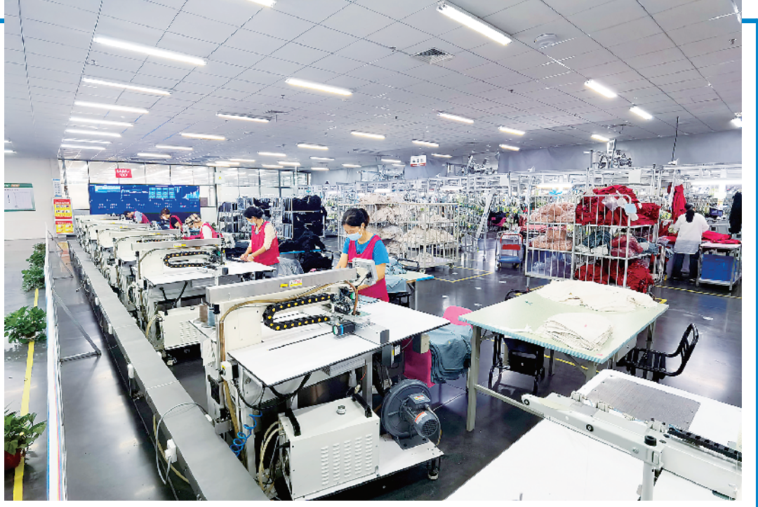
河南盛泰针织年产600万件高档成衣生产线数字化改造项目，总投资1.2亿元，主要购置智能针织机和自动裁剪、智能仓储设备等各类智能化设备及软件系统共1260台(套)。目前项目已投产，能耗降低18%，生产成本下降15%，产品附加值增加12%。图为工人正在赶制订单产品。记者 王映摄
